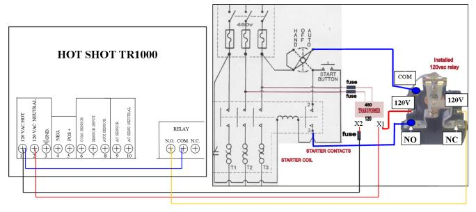
**PUMP START:** WHEN THE HOT SHOT AT THE PIVOT'S SENSOR INPUT TO SESNOR COM IS CLOSED IT SENDS OUT THE RELAY ON COMMAND TO THE HOT SHOT AT THE PUMP. WHEN A RELAY ON COMMAND IS RECEIVED THE HOT SHOT WILL CLOSE ITS N.O. TO COM CONTACTS AND LIGHT UP THE RELAY LED. THIS WILL ENERGIZE THE 120VAC RELAY TO CLOSE THE 480V PUMP CONTACTOR STATRTING THE PUMP.
